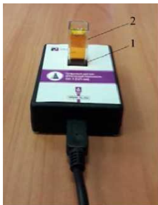
Рис. 1. Датчик оптической плотности: 1 – гнездо для кюветы; 2 – кювета для исследуемого
